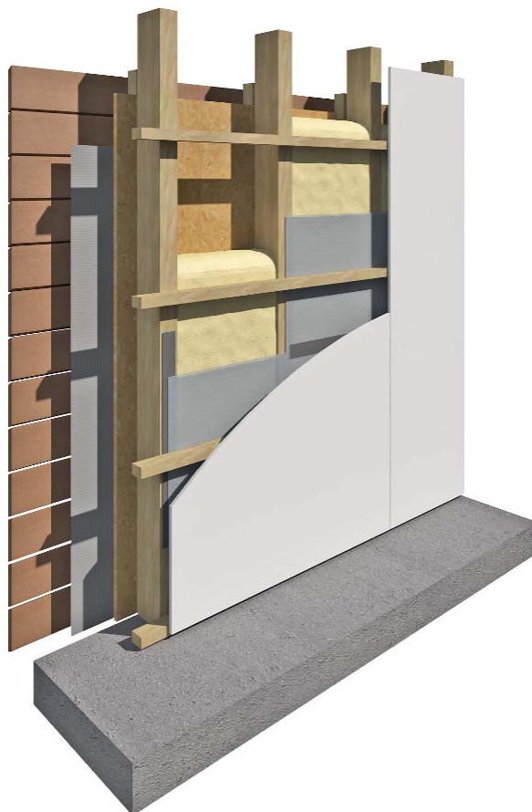
Figure 9 : Système constructif entre montants en bois
