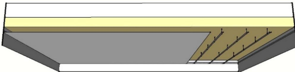
**Figure 3 : Plafond constitué de fourrures et de dispositifs**
