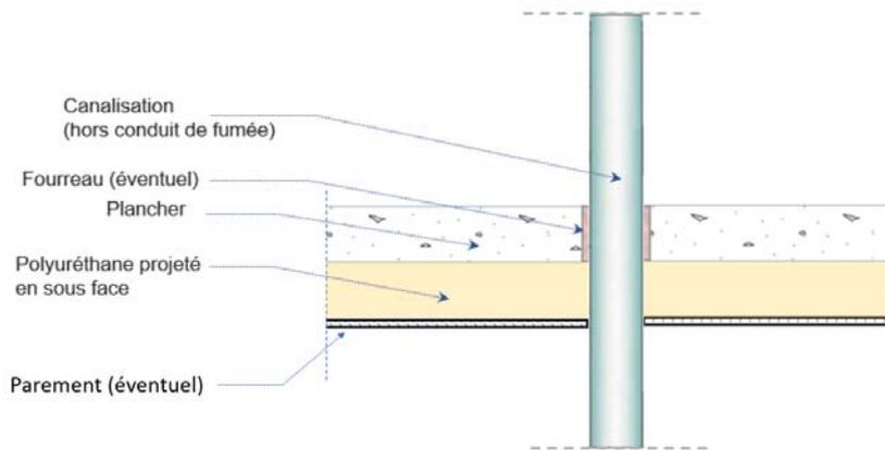
**Figure 2 : Traitement d'une canalisation verticale**
