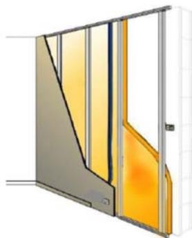
**Figure 9 : Contre-cloison constituée de fourrures avec appuis intermédiaires clipsés**
