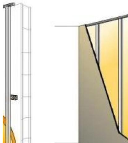
**Figure 10 : Contre-cloison constituée de fourrures avec appuis intermédiaires clipsés**
