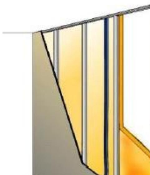
**Figure 9 - Contre-cloison constituée de montants simples ou doubles sans fixation intermédiaire au support**
