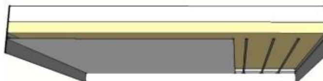
**Figure 7 : Plafond constitué de montants simples ou doubles sans dispositif de suspension au support (hors ERP)**
