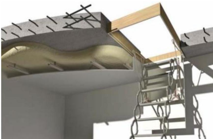
**Figure 3 - Traitement de la trappe d'accès aux combles**
