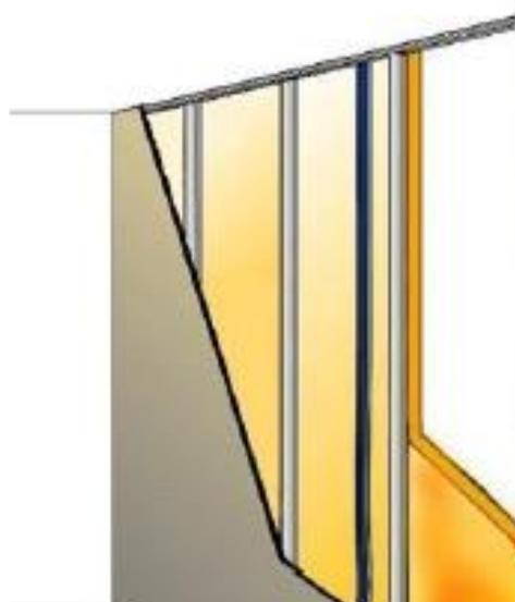
**Figure 7 : Contre-cloison constituée de montants simples ou doubles sans fixation intermédiaire au support**
