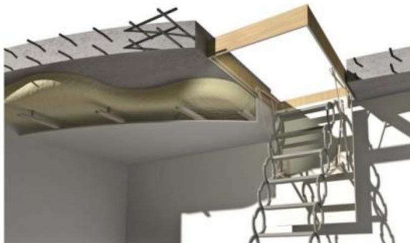
**Figure 3 : Trappe d'accès aux combles**
